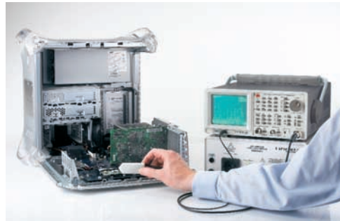
Ermittlung der abgestrahlten Stör- energie mit Hilfe der Magnetfeld- Sonde (H-Feld-Sonde) und dem Spektrumanalysator.
