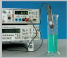
Temperaturmessung mit HZ812 in Verbindung mit HM8012
