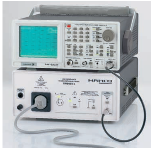
Messung von leitungsgeführten Störungen mittels Spektrumanalysator und Netznachbildung.
