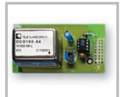
Option H085, ein hochstabiler Oszillator mit einer Stabilität von \pm 5 \times 10^{-7} pro Tag
