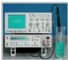
Genauere Temperatur- messung mit Messfühler
